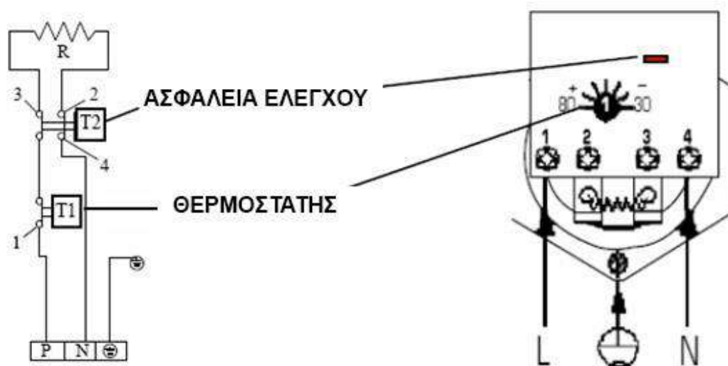
Εικόνα 9: Διάγραμμα σύνδεσης παροχής ρεύματος στο θερμαντικό σώμα μέσω του θερμοστάτη.
