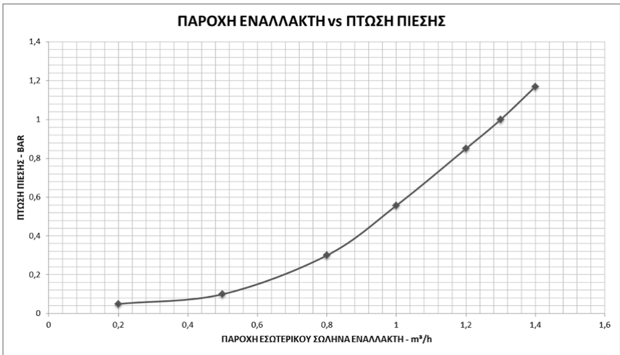
Εικόνα 5.1 Πτώση πίεσης στον ταχυεναλλάκτη ZNX 0,8m³/h
